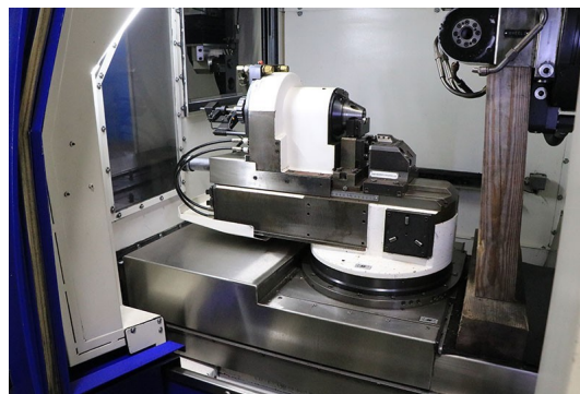
Área de trabalho em outro ângulo, com cabeçote, apoio e conjunto de retificação
